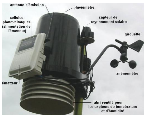
Photo 1 : Abri, capteurs et émetteur d'une station météorologique amateur.
