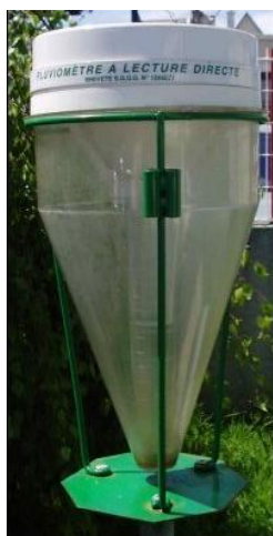
Photo 1 : Pluviomètre manuel de type SPIEA.
