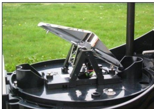
Photo 2 : gros plan sur le dispositif à augets basculants d'un capteur pluviométrique
