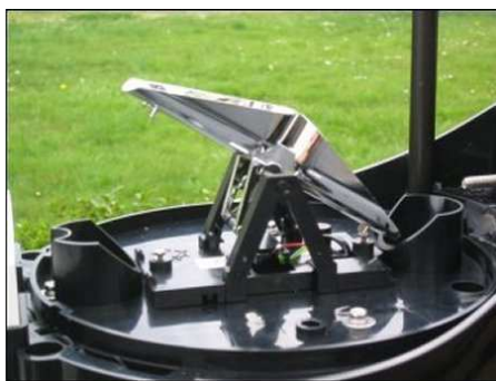
Ci-dessus Gros plan sur le dispositif à augets basculants du capteur pluviométrique d'une station automatique « amateur ».
