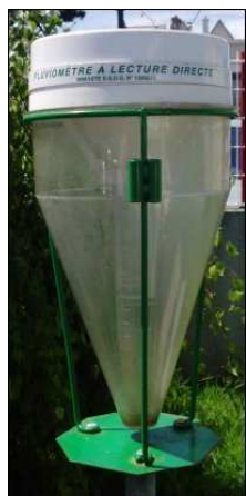
Ci-dessus Pluviomètre manuel de type SPIEA. Pour ce modèle, d'un diamètre de 225 mm, le cône de réception offre une
