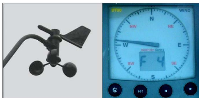
La mesure du vent s'effectue maintenant le plus souvent à l'aide d'un combiné girouette-anémomètre fixé sur un support et relié à un dispositif électronique permettant d'afficher simultanément la direction, (selon une rose des vents) et la force du vent (soit en échelle Beaufort comme ci-contre, soit sous la forme d'une vitesse exprimée en  $m.s^{-1}$  ou en  $km.h^{-1}$  ou en nœuds).
