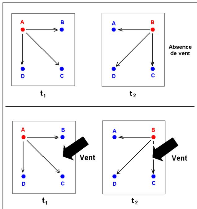
A, B, C, D, sont des transducteurs ultrasonores disposés en quatre points équidistants (exposés au vent) et pouvant fonctionner soit en émission, soit en réception, selon des séquences imposées.
