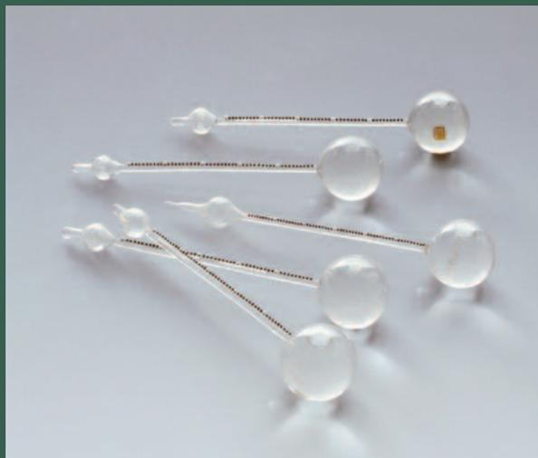
Figure 2. Exemplaires du thermomètre à alcool utilisé par Ismaël Boulliau. Le tube de verre comporte 50 graduations. Grâce à l'extraordinaire habileté de Mariani, le souffleur de verre du Grand Duc Ferdinand II de Toscane, ces thermomètres donnaient des mesures comparables (Middleton, 1969). Museo Galileo, Florence, Photo Franca Principe et Sabina Bernacchini.
