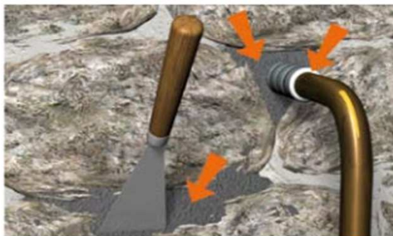
Situation après travaux : colmatage des voies d'eau.
