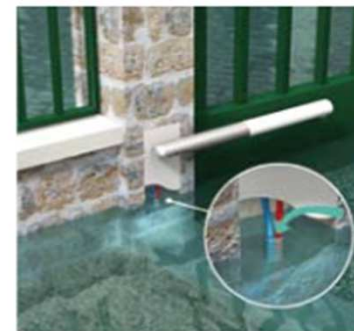
Passage possible de l'eau par les entrées de gaine.
