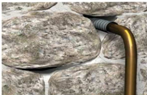
Situation initiale : passages possibles de l'eau à travers le mur.
