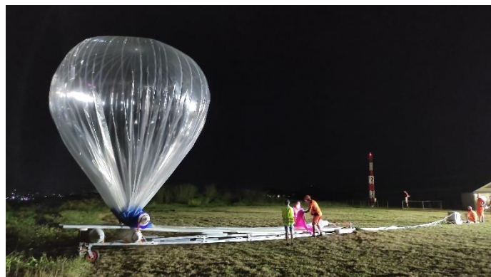
Fig. a : Préparation d'un ballon de 13m de diamètre avant son lâcher de nuit. Au sol, la poche de gaz se réfugie au sommet de l'enveloppe dont la partie inférieure est allongée sur une table. Une fois au plafond le gaz emplit toute l'enveloppe qui est sphérique et en surpression par rapport à l'atmosphère extérieure. Les charges utiles sont visibles à droite. Crédits : Albert Hertzog (IPSL/LMD)
