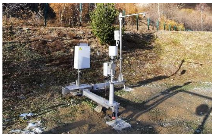
Fig. 2 - Station Mercury avec capteur hauteur de neige à St-Sorlin-d'Arves (73)
